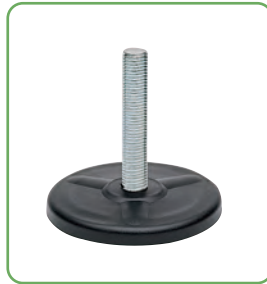
Part. R0031 - Pag. R49 Ø 110 • Rubber • Max. load 6000 N.
