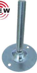
Part. R0441 - Pag. R40 Ø 123 • N. 2 holes • Zinc plated steel • Max. load 10000 N.
