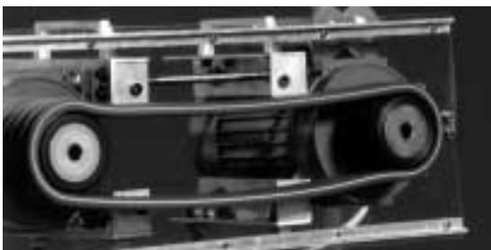
Schwingungen in einem ungespannten Kettenbetrieb Vibrations in an untensioned chain drive
